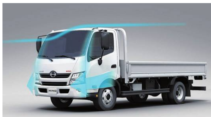
Рис. 1: Большой угловой радиус и обтекаемая форма кабины улучшают аэродинамические характеристики автомобиля.
