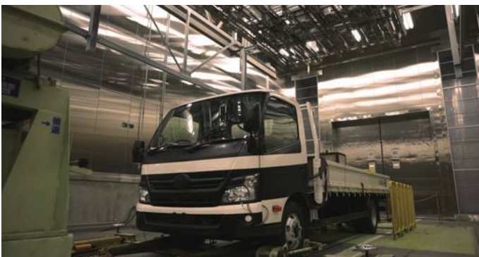
Тесты на надежность деталей проводились в камере для моделирования окружающей среды при температурах от +50 до -40 °C
