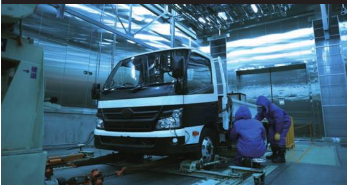
Тесты на надежность деталей проводились в камере для моделирования окружающей среды при температурах от +50 до -40 °C
