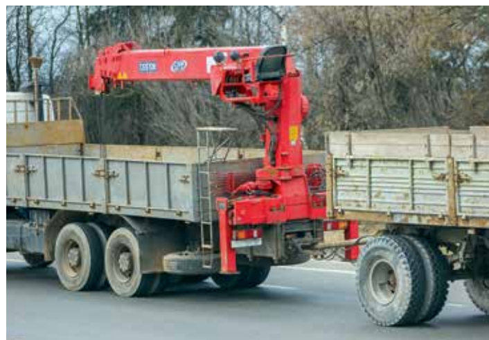
Расположенная на заднем свесе рамы тягача КМУ позволяет перемещать грузы на платформе грузовика и прицепа без их растаскировки.
