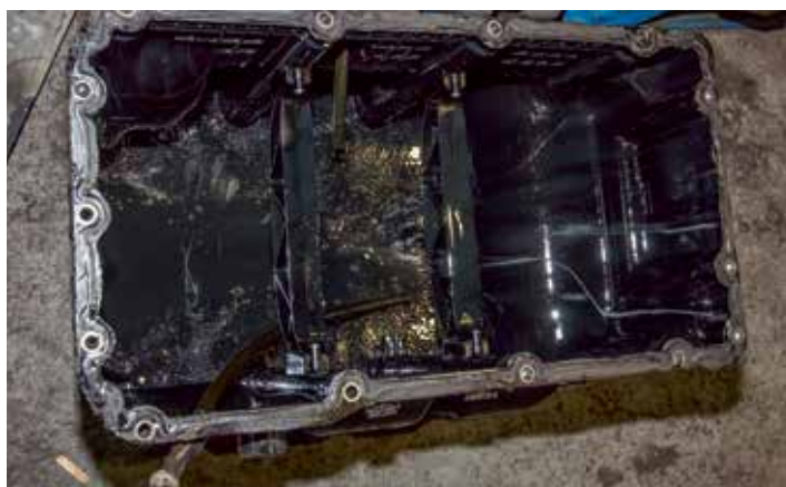
Отложения на дне картера нередко приходится первоначально удалять скребками.
