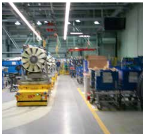
Автоматизированный участок сборки двигателей.
