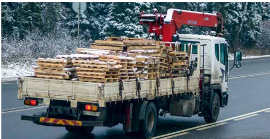
Перегруз передней оси грузовика, который может возникнуть при размещении стрелы КМУ над кабиной, особенно опасен на зимней дороге, где крайне важна хорошая управляемость транспортного средства.
