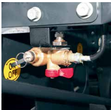
Кран обязательно проверяют на герметичность.
