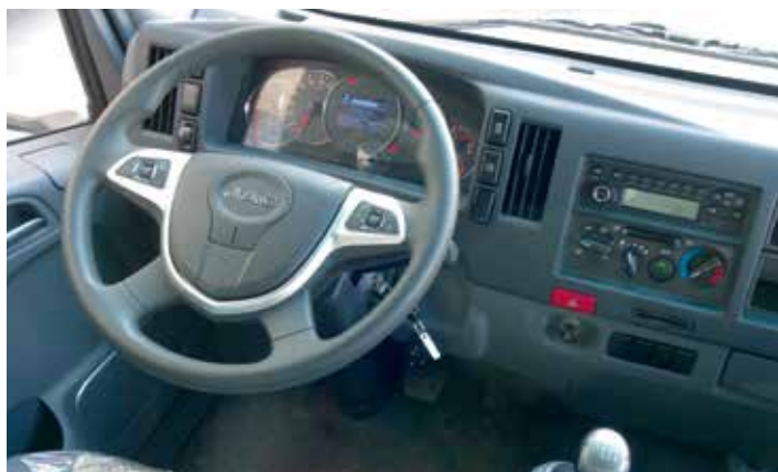
Мультифункциональный руль не закрывает обзор щитка приборов.
