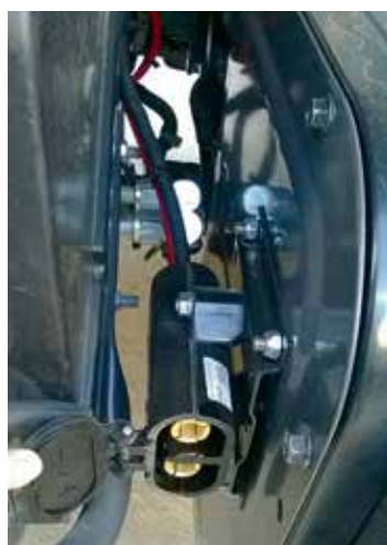
Пусковую розетку для питания гидростанции поставили на ящик АКБ.
