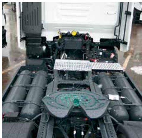
Баллоны с метаном по обеим сторонам рамы.
