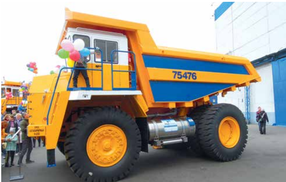
Новый 45-тонный самосвал БелАЗ-75476, работающий на сжиженном природном газе.
