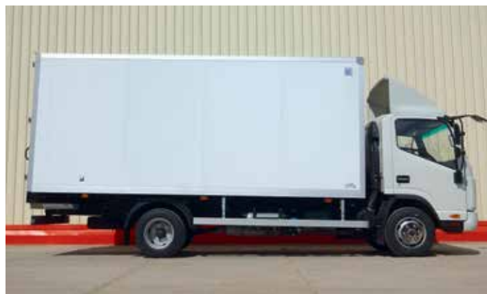
При колесной базе 3845 мм монтажная длина достигает 5155 мм.
