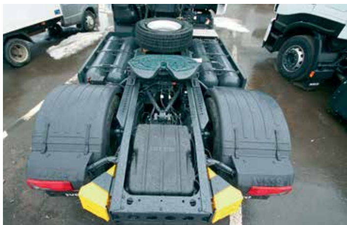
Разумное решение: ящик АКБ размещен внутри рамы.
