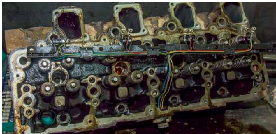
Чтобы качественно отмыть головку блока цилиндров перед ее ремонтом, необходимо использовать автоматическую установку с подогревом моющего раствора.
