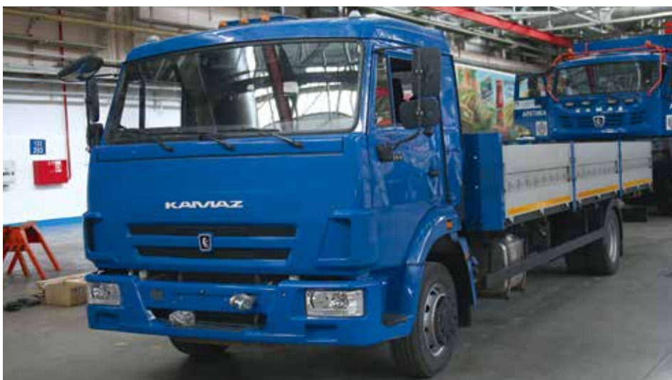
Пилотные образцы «Одиссей» собраны на шасси КамАЗ-43083.
