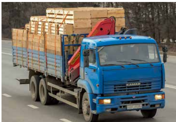
Размещаемая в транспортном положении за кабиной стрела КМУ не ограничивает габариты перевозимого груза.
