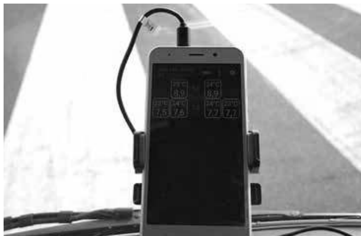
Датчики контролируют давление в каждой из шин тягача. Это гарантирует одинаковые условия тестирования.
