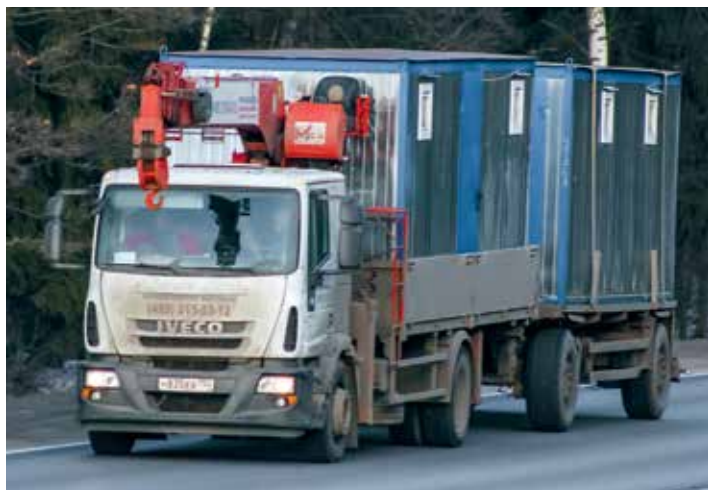
КМУ с длинной стрелой и мощной лебедкой позволяет работать с крупногабаритным грузом.
