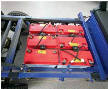
Блок батарей для привода трицикла RuTrike.
