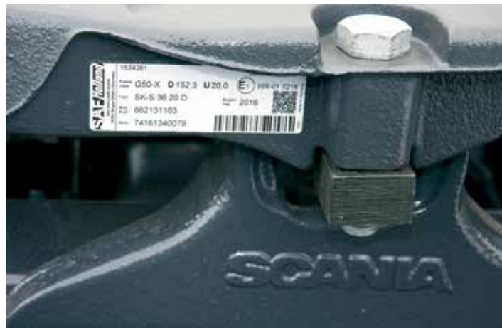
Маркировка устройства SAF-Holland 2016 года выпуска указывает название и код конкретной модели.
