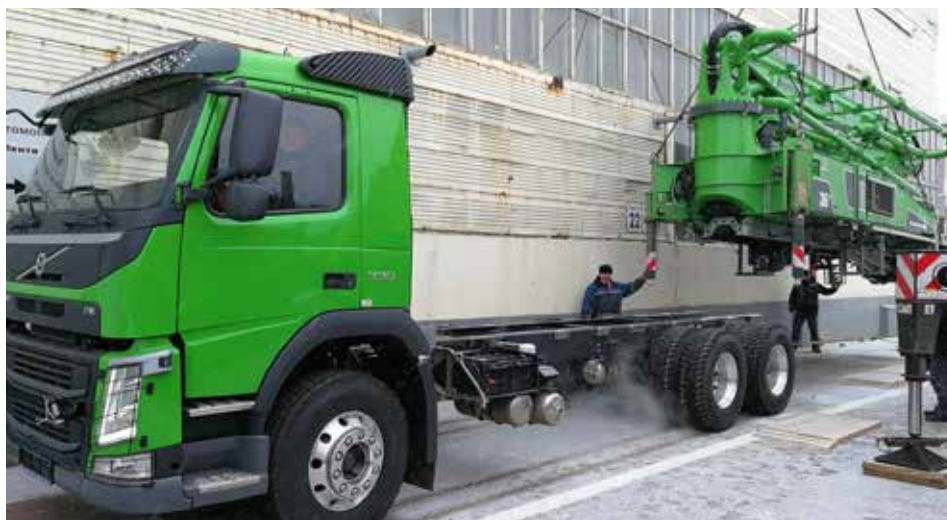
Трехосное шасси Volvo FM (6х4) под монтаж надстройки Putzmeister.
