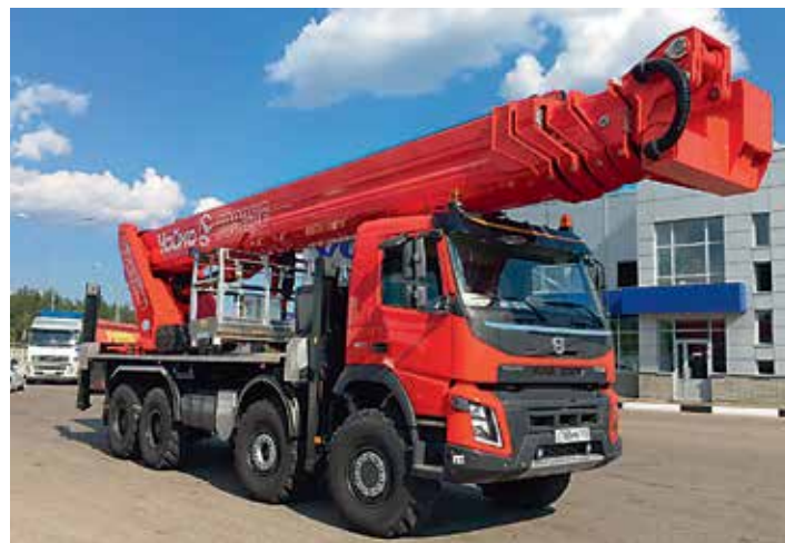
Подъемник с высотой стрелы 70 м смонтирован на шасси Volvo FMX (8x6).
