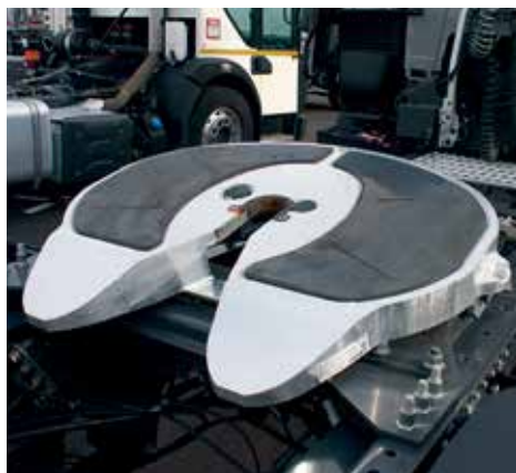
Современные полуавтоматические «седла» отличаются наличием накладок из полимера.
