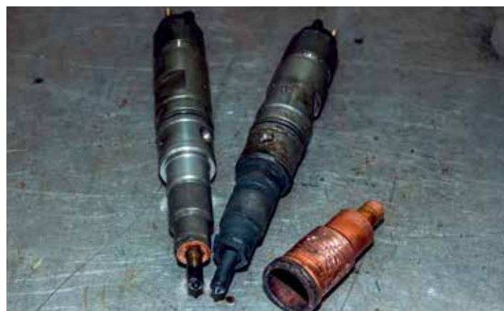
Мойка агрегатов топливных систем идет в две стадии: ручная и автоматическая в ультразвуковой ванне.
