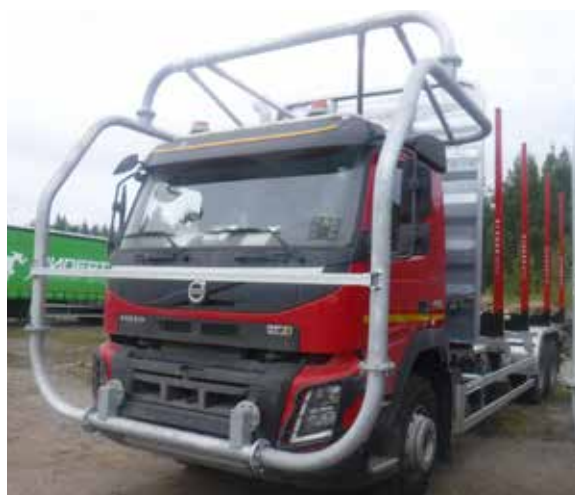
Лесовозное шасси Volvo FMX (6x4) с защитой кабины от падения бревен в эксклюзивной доработке российских инженеров.
