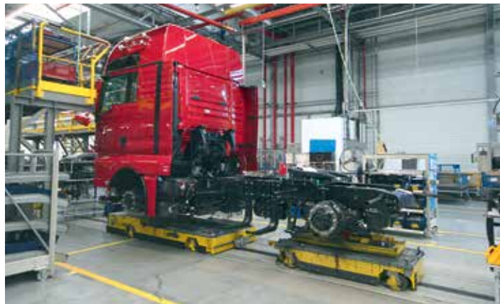
На конвейере применяются роботизированные тележки.
