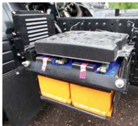
Аккумуляторный ящик на левой стороне рамы.
