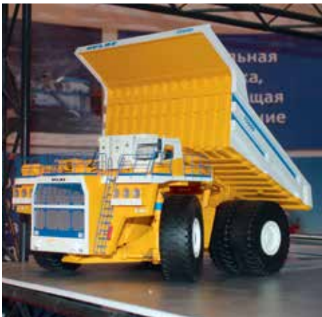
Макет карьерного самосвала БелАЗ-75600 грузоподъемностью 320 т.
