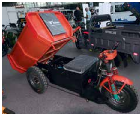
Самосвальная версия для строительных работ.
