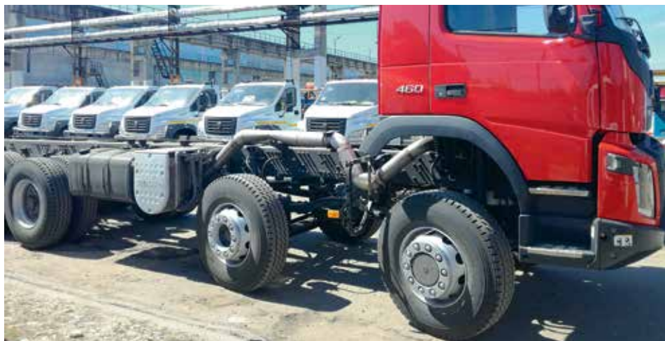
Шасси Volvo FM (8x4) перед адаптацией под надстройку «Чайка Socage».
