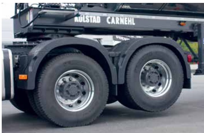
Седельники с подъемной задней осью позволяют сместить ССУ ближе к заднему свесу.
