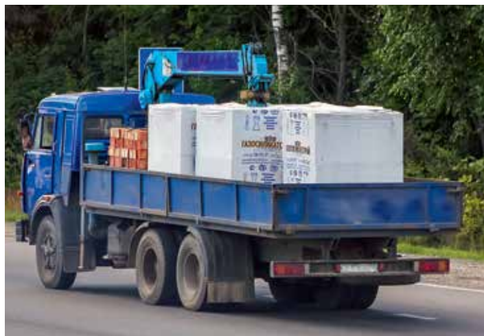
Транспортное положение стрелы над грузом ограничивает его габариты по допустимой высоте.
