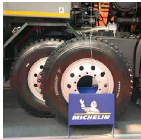
Выносливые шины Michelin X для карьерных самосвалов размером 12.00 R2 XDL.
